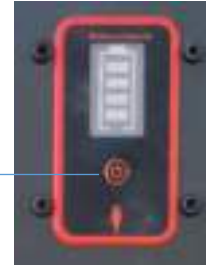
Niveau de batterie et bouton RESET
