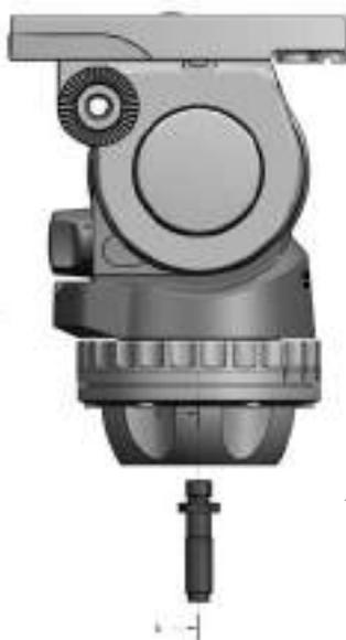
Um den FSB 4 mit Flachbodenanschluss verwenden zu können, muß der Gewindezapfen entfernt werden.
